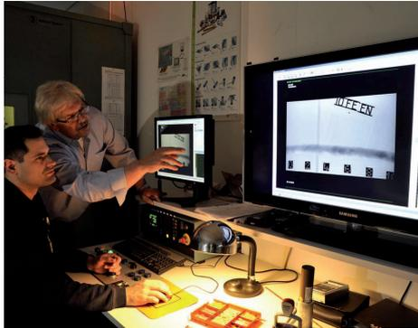
Die digitale Radiologie befasst sich wie die herkömmliche Durchstrahlungsprüfung mit dem Auffinden von Inhomogenitäten und Fehlstellen im gesamten Querschnitt des Prüfstücks. Hierbei wird durch analoge und digitale Detektoren zur Bildgewinnung der chemische Entwicklungsprozess herkömmlicher Röntgenfilme ersetzt.
